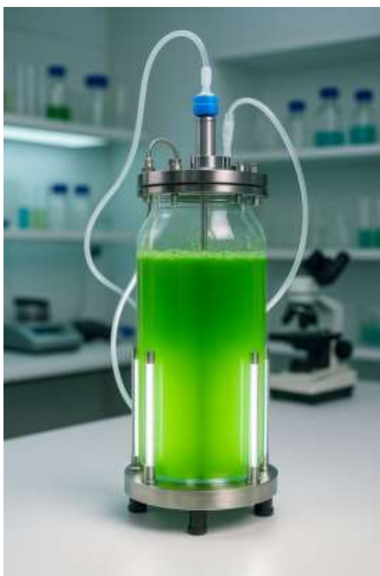
شکل (۲): نمایی از یک بیوراکتور نوری برای کشت جلبک در محیط آزمایشگاهی
